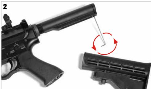
**Abrir la tapa del buffer tube** con una llave hexagonal.
