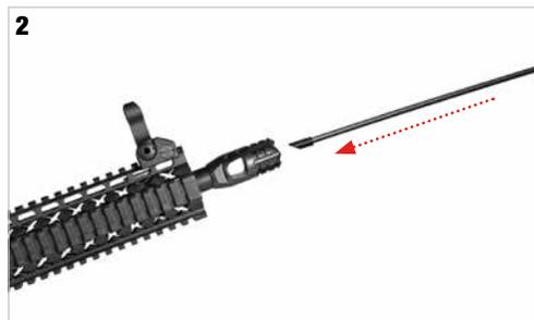
In caso di **inceppamento di pallini difettosi** all'interno della canna o della camera dell'Hop Up **interrompere immediatamente** l'utilizzo, portare l'Hop Up in posizione di riposo, estrarre il caricatore **ed utilizzare lo scovolo** per estrarre il pallino inceppato dal foro di alimentazione dell'Hop Up.
