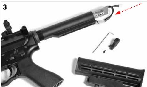
**Insertar la batería** en el buffer tube y **conectar los conectores como en la imagen.**
