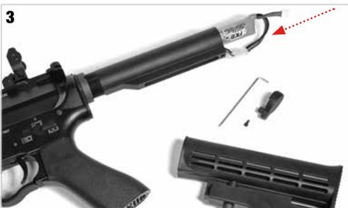
Inserire la batteria nel buffer tube **e connettere i connettori come in figura.** Rimettere il tappo e **riposizionare il calcio sul buffer tube.**
