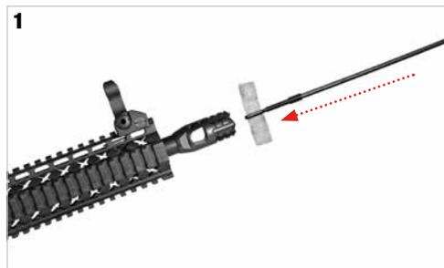
Después de **cada uso** limpiar **adentro del cañón** con un **cepillo** enroscando en la punta un trozo de trapo mojado con **aceite al silicon spray**.
