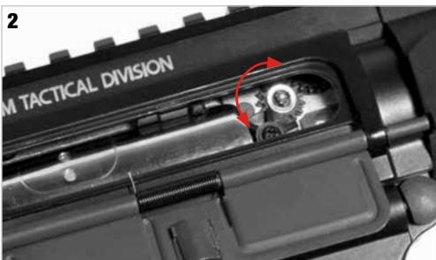
Regolare l'Hop Up tramite **l'apposita ghiera** ruotando **verso destra** per aumentarne l'effetto e **verso sinistra** per diminuirlo.
