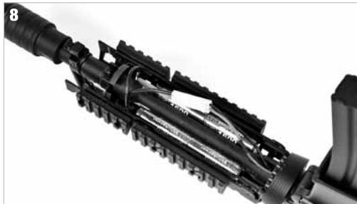
**Insertar la batería** en el guardamanos como en la imagen **y conectar los conectores.** Colocar los conectores **debajo del cañón** como en la imagen.
