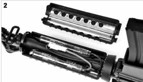
**Insertar la batería** en el guardamanos como en la imagen **y conectar los conectores.** Colocar los conectores **por encima** del cañón como en la imagen.
