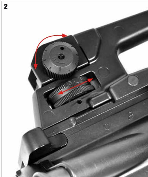
Per collimare il mirino posteriore con il punto d'impatto **ruotarlo in senso antiorario** per spostarlo a **sinistra** ed in **senso orario** per spostarlo a **destra**. Per la regolazione in alto ed in basso del mirino posteriore ruotare la ghiera **in senso orario per alzarlo** ed **in senso antiorario per abbassarlo**.
