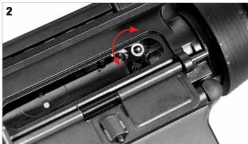
Regolare l'Hop Up tramite **l'apposita ghiera** ruotando **verso destra** per aumentarne l'effetto e **verso sinistra** per diminuirlo.
