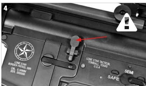
Premere la parte superiore della leva bolt catch per far **richiudere** l'otturatore.
