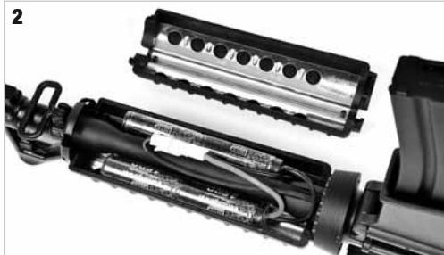
**Inserire la batteria** come in figura e **collegare i connettori**. Posizionare i connettori **sopra la canna** come in figura.
