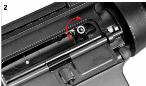
Ajustar el Hop Up mediante **su anillo girando hacia á la derecha** para aumentar el efecto y **hacia á la izquierda** para disminuir.
