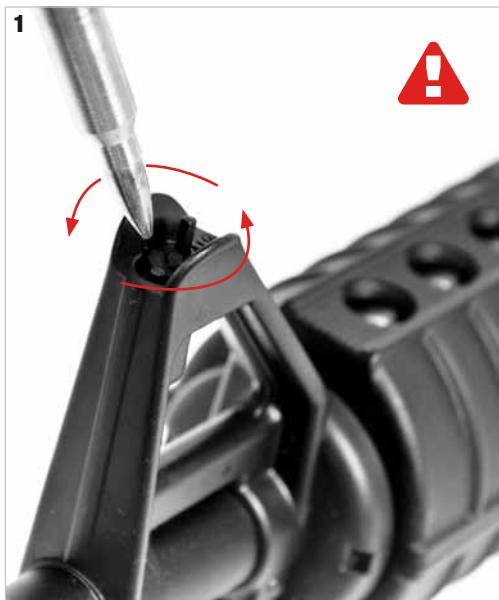
Per collimare il mirino anteriore con il punto d'impatto **ruotarlo in senso antiorario per alzare** il mirino e in **senso orario per abbassarlo**.
