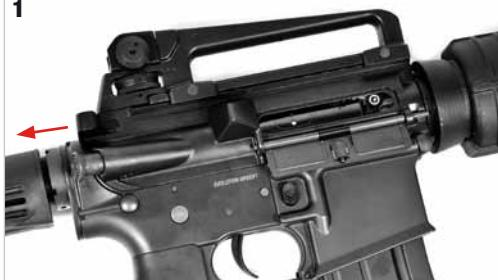
Para **bloquear** el cerrojo en posición trasera **tirar la palanca de montar**.
