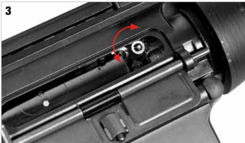
Dopo **ogni utilizzo azzerare** la regolazione dell'Hop Up per portare il meccanismo **in posizione di riposo**.
