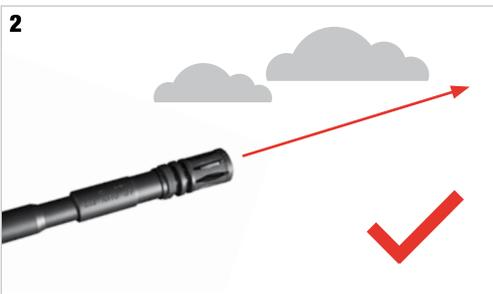
Direzionare la canna in **posizione sicura** e sparare due o tre colpi **a vuoto** in **modalità colpo singolo** per scaricare la molla di propulsione.
