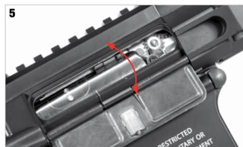
Regolare l'Hop Up tramite **l'apposita ghiera** ruotando **verso il basso** per aumentarne l'effetto e **verso l'alto** per diminuirlo.
