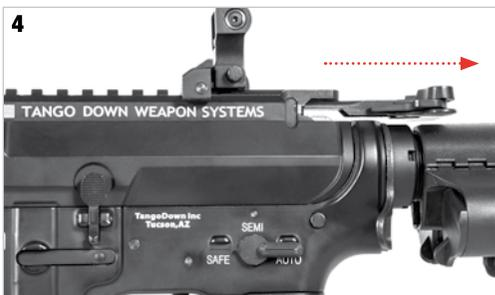
Per effettuare **la regolazione** dell'Hop Up Up **tirare la leva di armamento** per **bloccare** l'otturatore in apertura.
