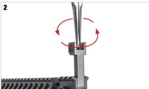
Per collimare il mirino anteriore con il punto d'impatto **ruotarlo in senso antiorario per alzare** il mirino e in **senso orario per abbassarlo**.
