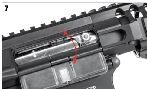
Dopo **ogni utilizzo** **azzerare** la regolazione dell'Hop Up per portare il meccanismo **in posizione di riposo**.
