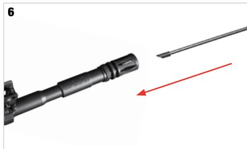
In caso di **inceppamento di pallini difettosi** all'interno della canna o della camera dell'Hop Up **interrompere immediatamente** l'utilizzo, portare l'Hop Up in posizione di riposo, estrarre il caricatore **ed utilizzare lo scovolo** in dotazione per estrarre il pallino inceppato dal foro di alimentazione dell'Hop Up.
