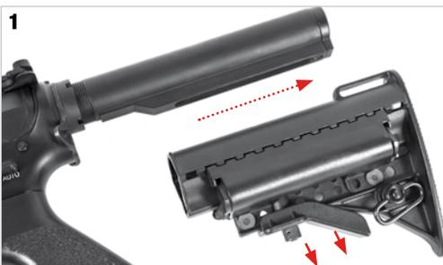
Para remover la culata **tirar la palanca hacia abajo y deslizar hacia atrás.**
