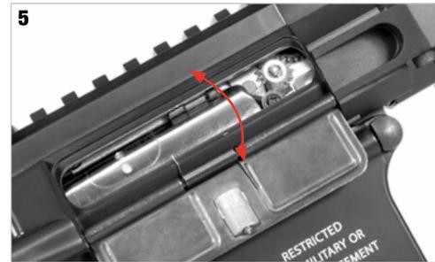
Ajustar el Hop Up mediante **su anillo girando hacia abajo** para aumentar el efecto y **hacia arriba** para disminuir.
