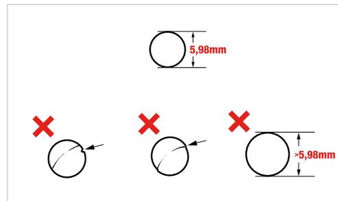
**Utilizzare esclusivamente pallini nuovi.** Non utilizzare pallini che presentano **parti non complete,** pallini **rotti** o con **diametro effettivo superiore a 5,98mm.**
