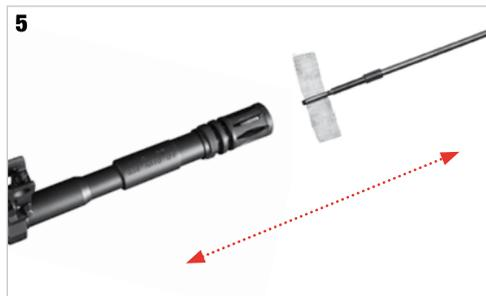
Dopo **ogni utilizzo** pulire l'interno della canna utilizzando **lo scovolo in dotazione** avvolgendo all'estremità una striscia di stoffa imbevuta di **olio al silicone**.
